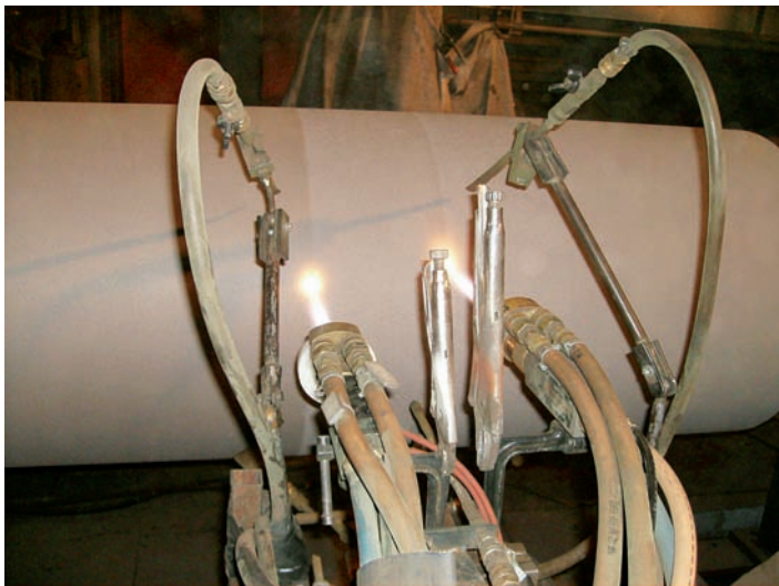
Bild 2: Cermet Beschichtung einer Tragtrommel, eigenes Bild
